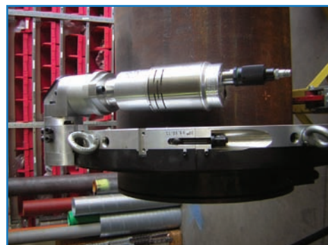
Engranaje angular para procesamiento en espacios limitados
