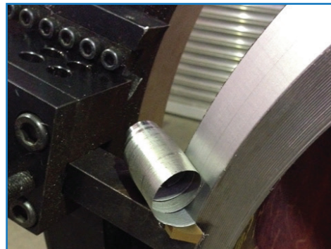
Alta eliminación de metal en P91 tubo
