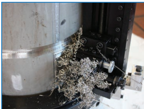
Eliminación longitudinal de la costura de soldadura
