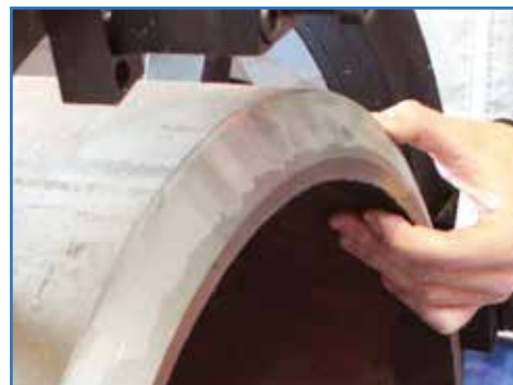
Tratamiento de grande espesor de pared
