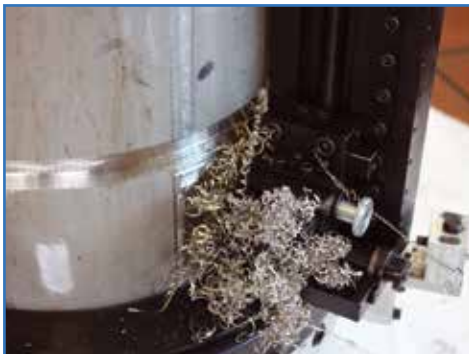
Eliminación longitudinal de la costura de soldadura
