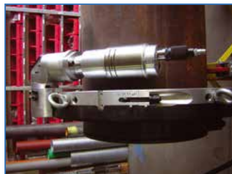
Engranaje angular para procesamiento en espacios limitados
