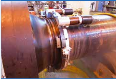
Doble motor para un gran espesor de pared
