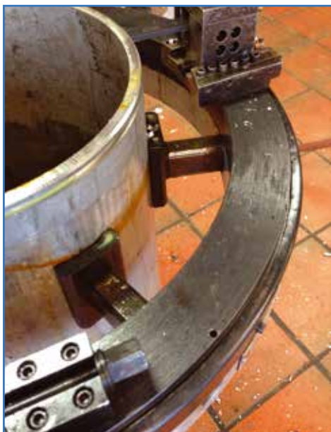
Patas especiales para espesores de tubos finos
